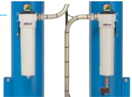
**Gli essiccatori sono forniti con un filtro disoleatore 0.01 micron in ingresso (con scaricatore automatico) e anti-polvere 1 micron in uscita. Dotati entrambi di manometro differenziale, sono facilmente raggiungibili per la manutenzione e rientrano nell'ingombro dell'essiccatore.**
