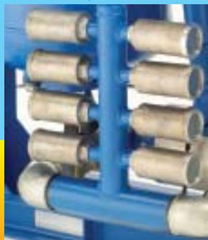
**I silenziatori, posizionati nella parte inferiore dell'essiccatore, sono facilmente accessibili per operazioni di smontaggio e/o sostituzione. Realizzati in fusione di alluminio, garantiscono la massima sicurezza durante la fase di depressurizzazione. Possono essere rigenerati con un semplice lavaggio in acqua calda e detergente.**
